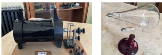
Figg. 13-14. Rocchetto di Ruhmkorff. Tubo di Crookes
