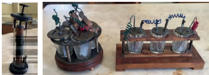
Fig. 8. Sinistra: pila di Volta a colonna. Destra: pile di Volta a tre e a quattro tazze
