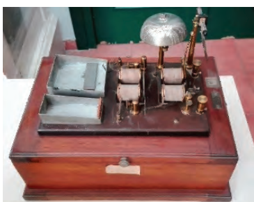
Fig. 8. Apparecchio per l'esperimento di Hertz-Righi
