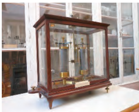
Fig. 4. Elettrometro a campo ausiliario di Bohnenberger
