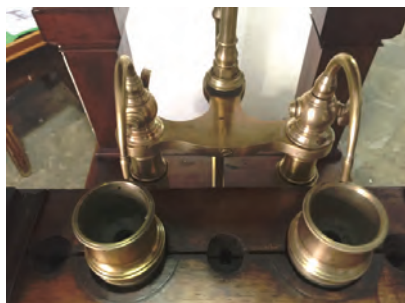
Fig. 4. Particolare dei recipienti in cui scorrono le cremagliere lubrificate dall'olio che esce dai beccucci ricurvi insieme all'aria evacuata dal recipiente
