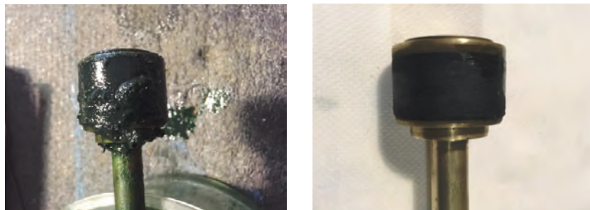
Fig. 6. Uno dei pistoni prima della pulizia (sinistra) e dopo (destra)
