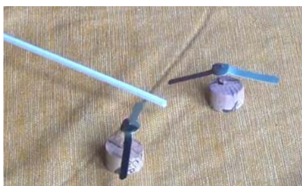
Fig. 3. Due versorium orientati da una cannuccia elettrizzata.
